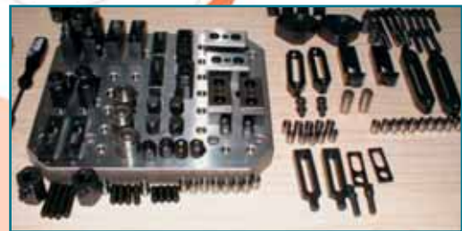
Laboratorul LaTInt, Secţiunea SeDiFleP, set modular pentru dispozitive AMF-M12
