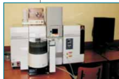
Spectroscoap de absorbție atomică (AAS) (Laboratorul de analiză instrumentală)
