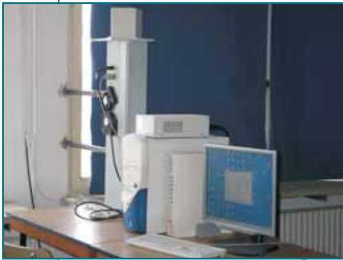
Platforma integrata de microscopie de forte atomice SPM INTEGRA Prima
