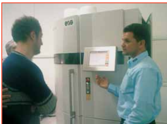
Mașina de prototipare cu pulbere din masă plastică Formiga P100
