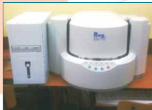
Spectroscoap dispersivă de energie de tip EDX (Laboratorul de încercarea și caracterizarea materialelor)
