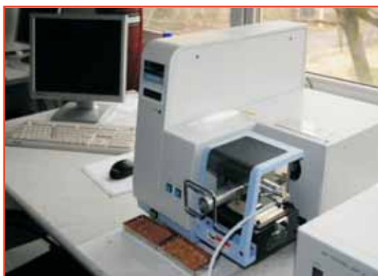
Analizor termic diferențial TG-DTA. Catacterizare combustibili solizi și lichizi
