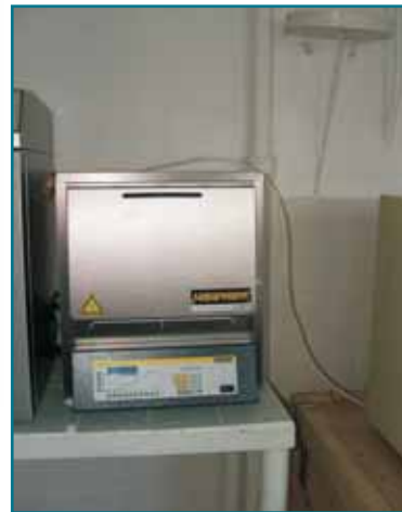
Cuptor de calcinare
