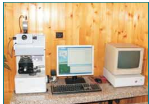
Durimetru Martens cu sarcină progresiv crescătoare (Laboratorul de încercarea și caracterizarea materialelor)
