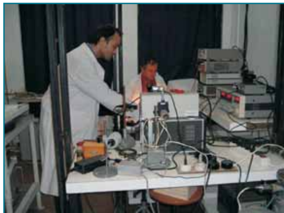
Simulator Solar cu lampa de Hg-Xe si filtre AM1.5
