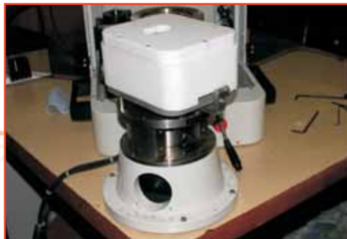
Modul pentru cercetarea tribologică a protezelor articulare de șold- montabil pe echipamentul universal de testări mecanice
