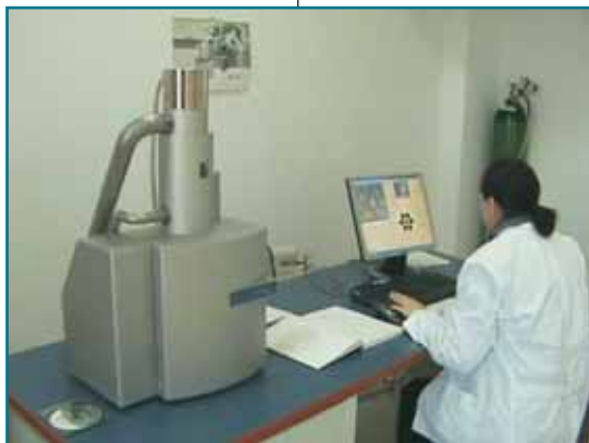
Microscop Electronic cu baleiaj TESCAN VEGA XM cu capabilități de electrono-litografie
