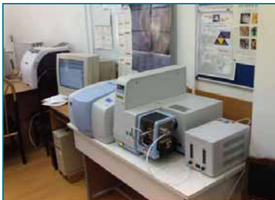
Sistem TG-DTA Perkin Elmer cu linie de transfer la Spectrometrul Spectrum 100 Perkin Elmer
