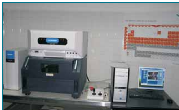
Microscop cu fluorescență de raze X model XGT-7000
