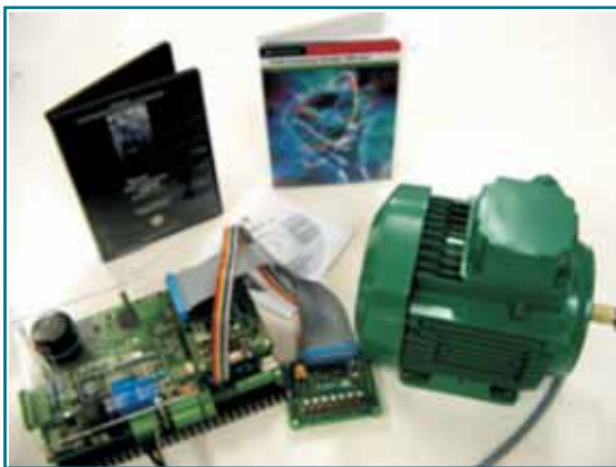
Sistem de acționare cu comandă numerică a unui motor de inducție trifazat utilizând librării MatLAB (laboratorul de acționări electrice)
