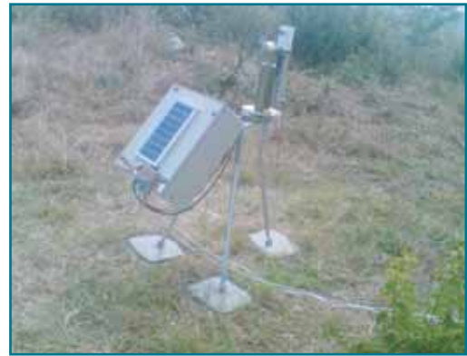
Fotometru solar model CE 318 integrat în rețeaua internațională AERONET condusă de NASA și LOA-PHOTOS (CNRS)
