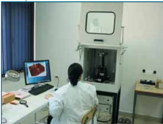
Microscop de Forță Atomică pentru caracterizări morfologice
