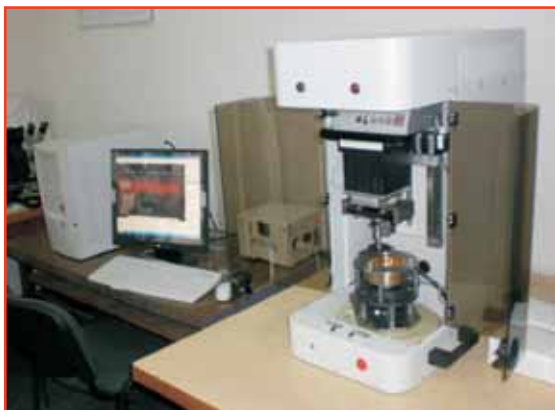
Modul pentru cercetarea tribologică a protezelor articulare de șold- montabil pe echipamentul universal de testări mecanice
