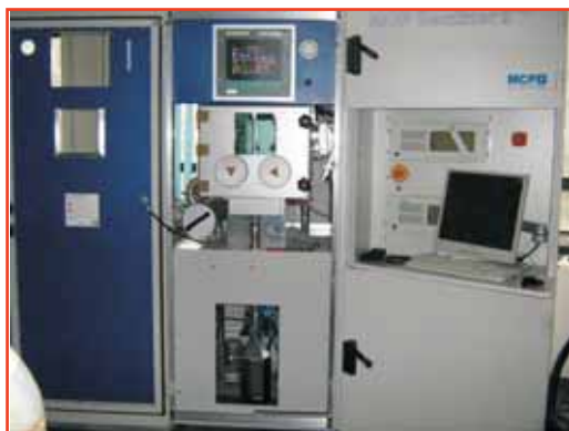
Echipament de topire selectivă cu laser, tip MCP Realizer II SLM 250
