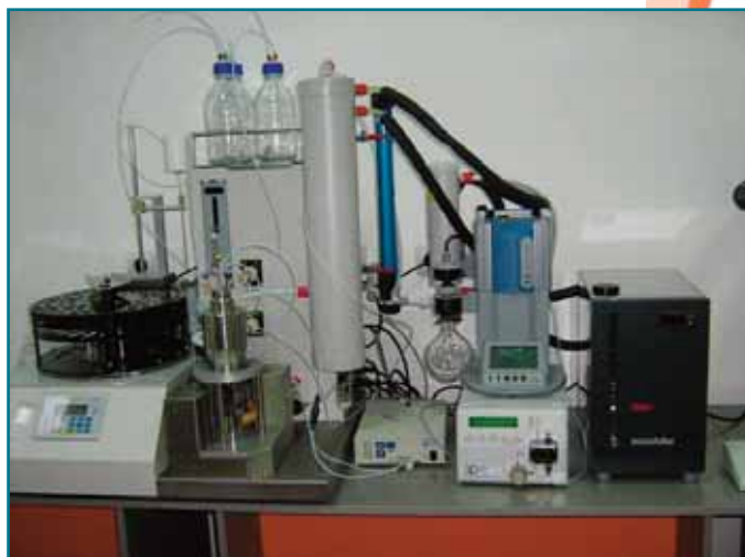
Sistem de gel permeație complet automatizat pentru concentrarea și purificarea probelor
