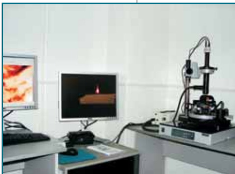
Platforma integrata de microscopie de forte atomice SPM INTEGRA Prima
