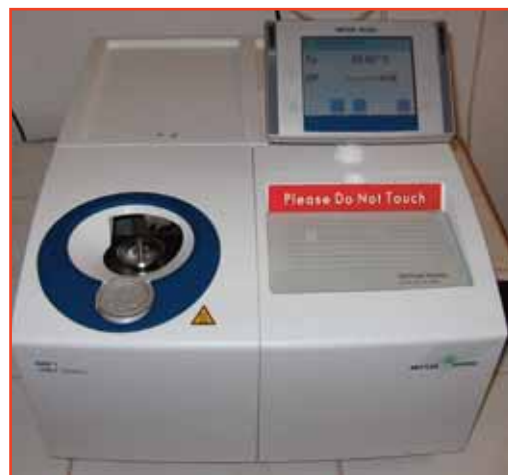
Calorimetru cu scanare diferențială DSC1 Mettler
