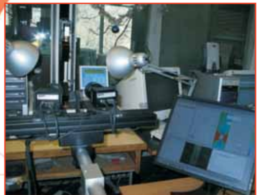
Masăină de încercări statice Lloyd LRX Plus 5 kN Static testing machine Lloyd LRX Plus 5 kN
