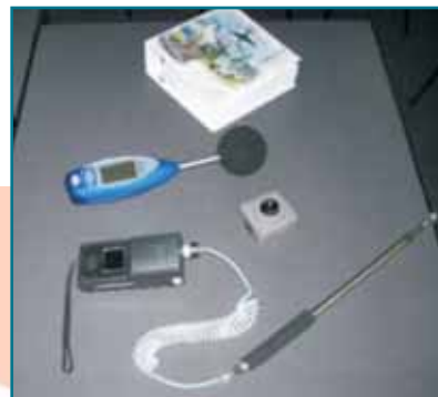
Sistem de trasare hartă zgomot și dispersie poluanți
