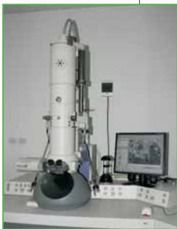
Microscopul electronic de transmisie TECNAI G2 Spirit pentru tomografie celulară și moleculară
