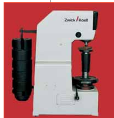
Durimetru Brinell ZHB 300 – cu utilizare în sistem computerizat
