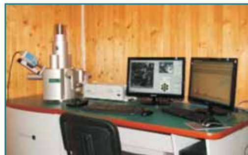
Microscop electronic SEM cu detector SE, BS, LVTSD ;i detector spectrometric dispersiv de energie EDX. (Laboratorul de încercarea și caracterizarea materialelor)
