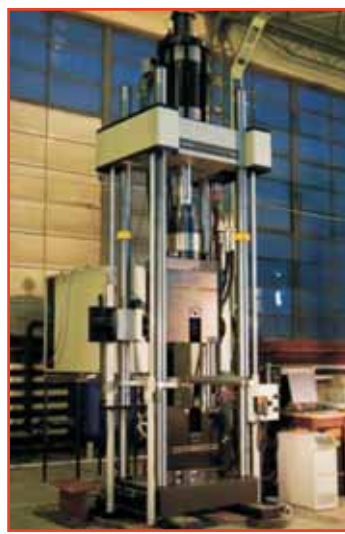
Presă dinamică 1000kN cu cameră de temperatură și accesorii
