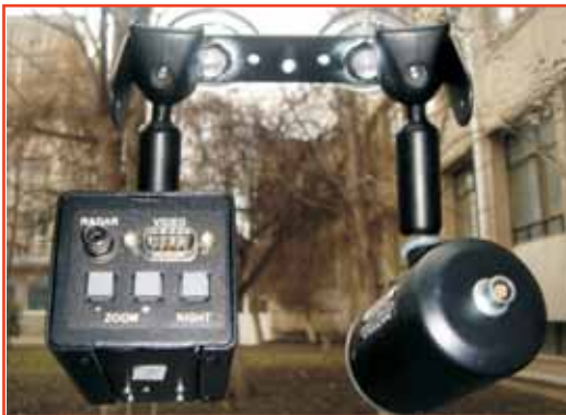
Cameră video și radar pentru monitorizare trafic
