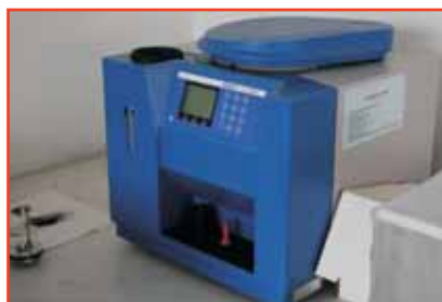
Calorimetru IKA 200. Determinarea puterii calorifice superioare IKA 200 calorimeter. High heating value determination.
