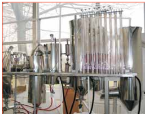
Sistem captare CO 2 pe bază de amine pentru instalații de ardere cu zero emisii
