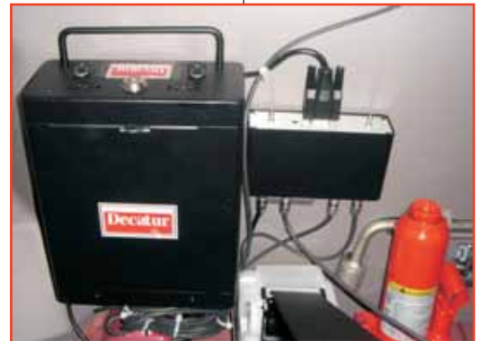
Sistem de stocare a imaginilor preluate de către camera video și sistem de distribuție a radarelor față/spate
