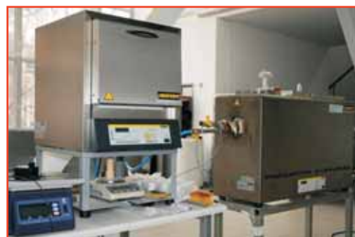
Instalații pentru determinarea caracteristicilor termo-fizico-chimice ale substanțelor solide și lichide. Procese termo-chimice de piroliză, gazeificare și combustie pe eșantioane de până la 100g.
