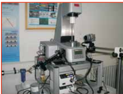
Reometrul Physica MCR 301, echipat cu sistem de vizualizare microscopică
