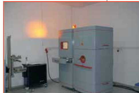
Mașina de prototipare cu pulbere metalică de tip Arcam S12
