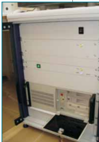
Profilmetru cu laser model Nanofocus μscan® (Laboratorul de Tribologie și Mecanica contactului)
