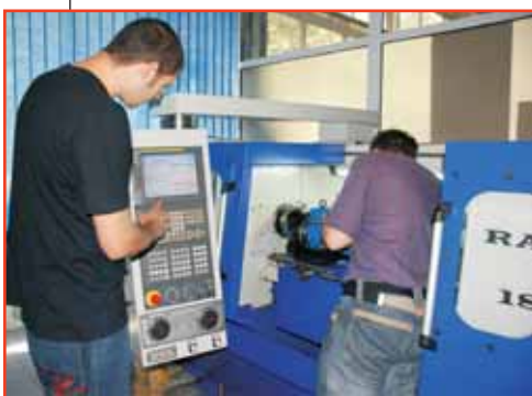
Strungul CNC de atelier din laboratorul de mașini unelte cu comandă numerică
