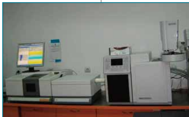
Gaz-cromatograf cuplat cu spectrometru FT-IR
