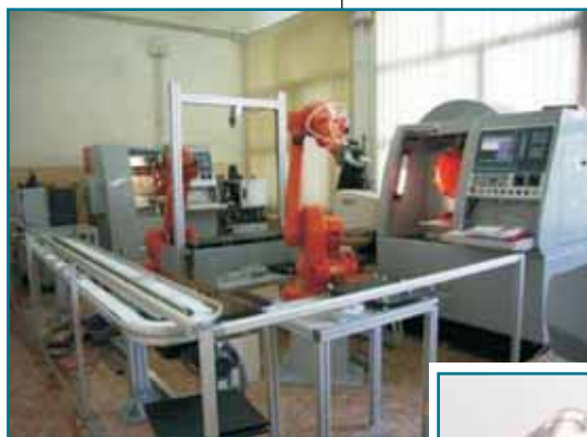
Celulă flexibilă cu 2 roboți, 2 mașini CNC și prehensoare inteligente
