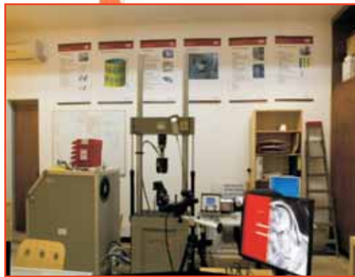
Mașină servohidraulică pentru încercări la oboseală 50kN Fatigue testing servo-hydraulic machine 50 kN
