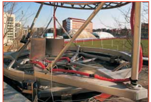
Sistem mecanic pentru poziționarea oglinzii parabolice Mechanical system for positioning the parabolic mirror
