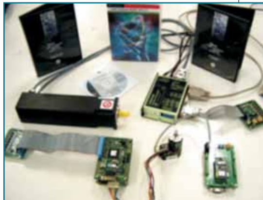
Sistem de acționare cu comandă numerică a motoarelor brushless DC, brushless AC (Laboratorul de acționări electrice)
