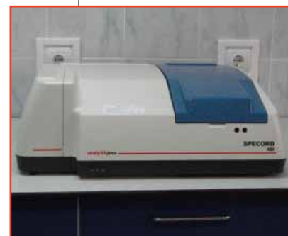
Spectrofotometru UV-Vis cu termostatare (Specord 210)
