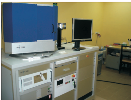
Difractometru de Raze X, pentru studii pe monocristal
