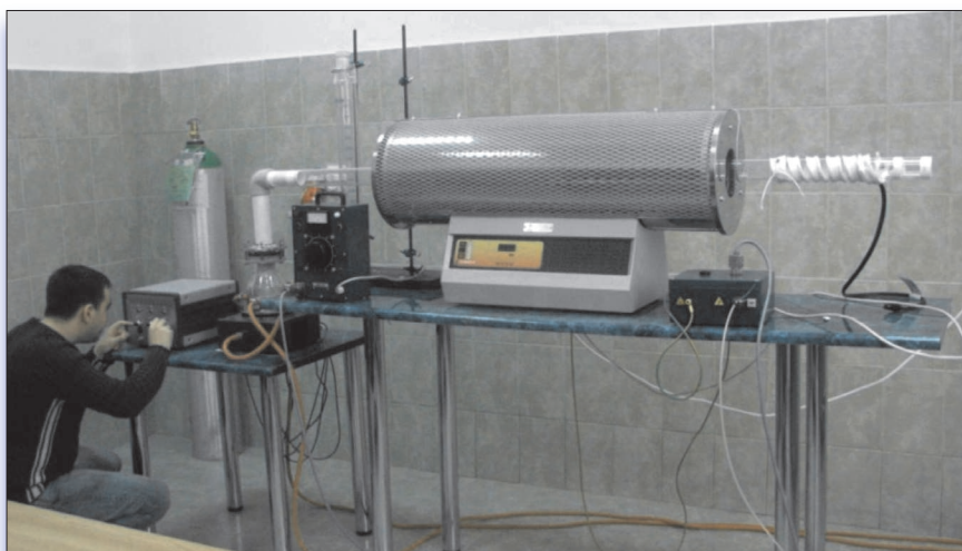
Instalație de sinteză în pirosoali a nanopulberilor
