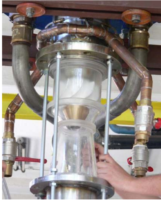
Figura 21 . Stand experimental (stânga) și secțiunea de test (dreapta) pentru investigarea vârtejului funie și a noilor metode de control al curgerii.
