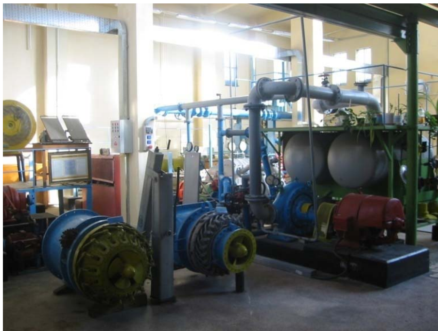
Figura 4. Turbinele Pelton de la Crăiniceș și standul de încercare al turbinei model de la Laboratorul de Mașini Hidraulice.
