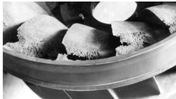
Figura 10. I. Anton, (1984, Vol. I, 1985, Vol. II), Cavitația , Ed. Academiei Române, București. Rotor Francis cu paletile erodate cavitațional (jos)
