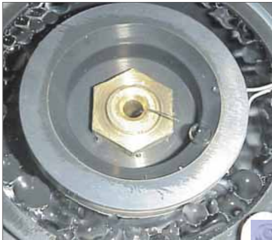
Vizualizarea vaporizării în filme subțiri (13 micrometri) cu aplicații la etanșările frontale realizată în cadrul programului post-doc de către T.Cicone la Univ. din Poitiers (2 nd World Tribology Conference, Viena 2001)
