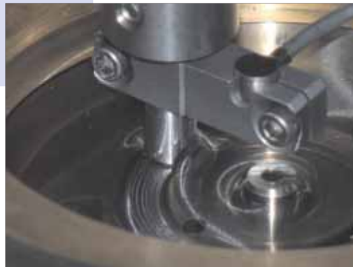
Evidențierea curgerii cavitaționale la un interstțiu treaptă, pe standul CETR UMT-2 (2010)
